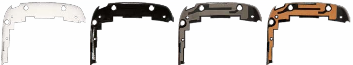
図4 写真左より ラピッドプロトタイプングで部品を作製、ペイント・コーティング、レーザで活性層を作製、無電流槽内で金属化によりメタルレイヤーを作製。
