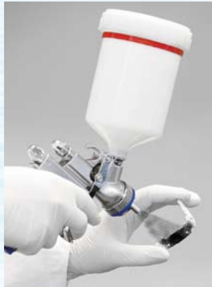
図2 LPKF社ProtoPaintLDSでのペイント・コーティングでLDS属性をどの様な部品にも付加可能。
