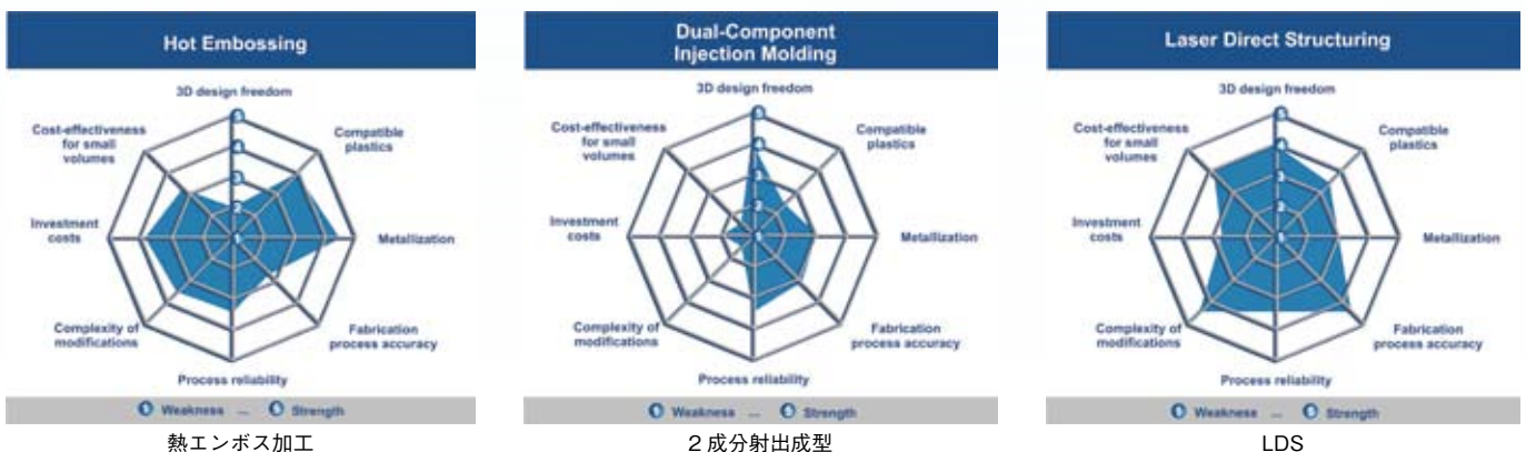
図1 3D回路部品を成型する3Dプロセスの比較。
