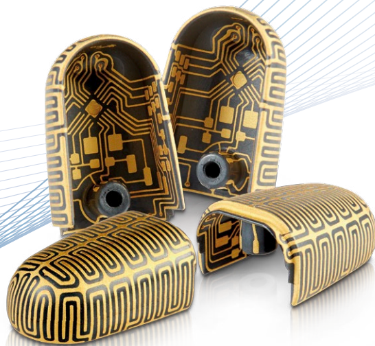
ロボットハンド用タッチセンサー (引用元: Citec, Bielefeld University)
