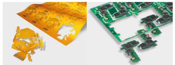
MicroLine による FPC 及び PCB カット
